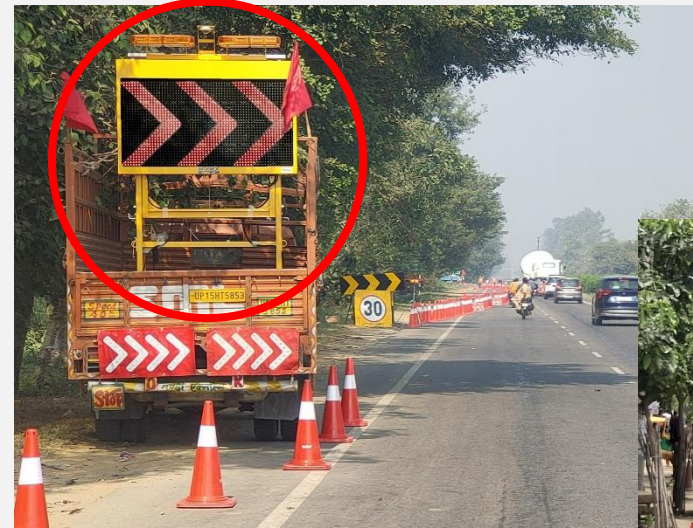
▲当社車載標識装置を用いた実証実験 (インド・デリー近郊ハイウェイ)
