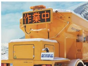
小型車載標識装置 (ヒーター付)
