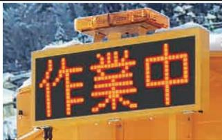
小型車載標識装置（ヒーター仕様）
