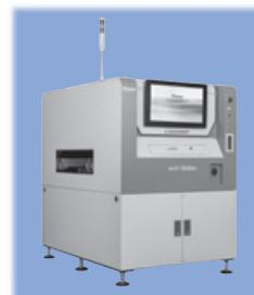
3D基板外観検査装置
