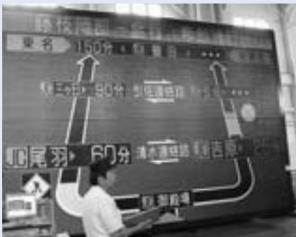
図形、文字、写真など多彩な情報提供が可能な大型の多目的情報板
